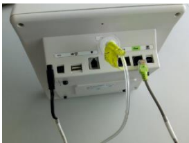
Fig 3: El cable de la izquierda se conecta a la fuente de energía. El filtro de en medio redondo se conecta dándole vueltas y es parte del sensor de CO 2 . El cable de la derecha también es parte del sensor y solo se debe enchufar.
