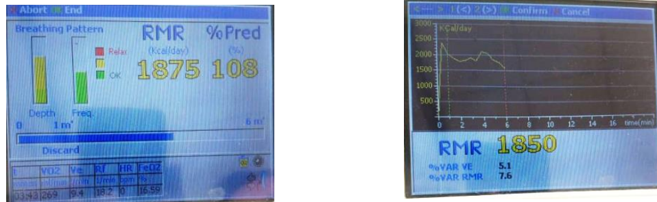
Fig 7: A la izquierda se muestra como durante el estudio se van arrojando resultados en tiempo real. A la derecha se observa la gráfica final del estudio
