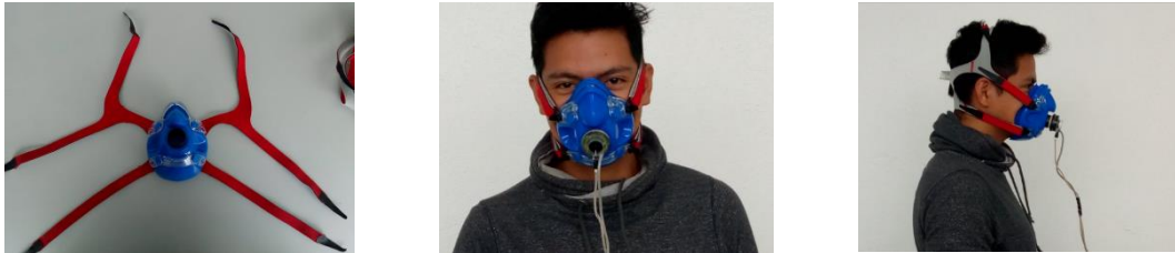
Fig 5: Del lado izquierdo se muestra la manera en que se debe ver la mascarilla una vez armada. Al centro y a la derecha se muestra como se debe conectar al sujeto de estudio. Las mascarillas ya estarán previamente armadas antes de la practica.
